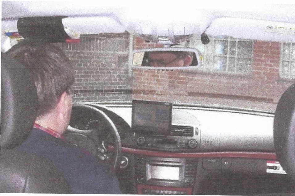
Abb. 3: Monitor im Bereich der Mittelkonsole stellt keine Sichtfeldeinschränkung dar.
