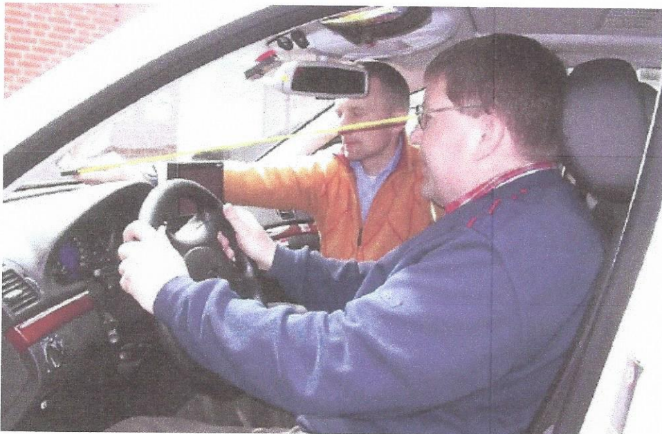
Abb. 4: Bei der Prüfung wird die Sichtlinie des Fahrers vermessen.
