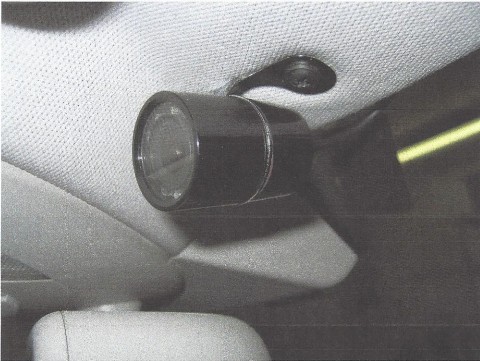
Abb. 2: Kamera am Fahrzeughimmel in der Nähe des Rückspiegels.
